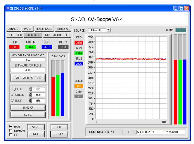
Nachdem die Kalibrierungsfaktoren von der Software auf der Benutzeroberfläche berechnet worden sind, werden sie automatisch in dem nichtflüchtigen Speicher **EEPROM** des Sensors abgelegt. Die Kalibrierung ist somit beendet und es kann im Hauptpanel weitergearbeitet werden.
