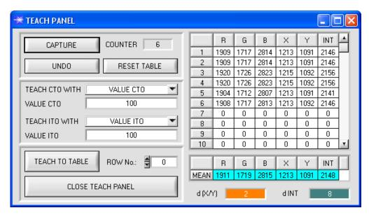
Das Hauptpanel bleibt bestehen und es werden automatisch Daten vom Sensor geholt und zur Anzeige gebracht. Durch Drücken von **CAPTURE** wird ein Parameter Frame in die Tabelle eingetragen.
