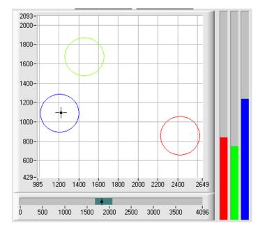
X/Y/INT bzw. s/i/M: Ein Panel öffnet sich, in dem die eingelernten Farbkugeln und die aktuelle Farbposition angezeigt werden. Zur besseren Darstellung wurde eine Dreiseiten Ansicht mit den Graphen X/Y (s/i), X/INT (s/M) und Y/INT (i/M) gewählt.
