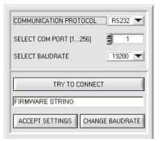
Zum Ändern muss zuerst über TRY TO CONNECT eine Verbindung aufgebaut werden.
