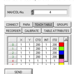
In diesem Beispiel wurde MAXCOL-No. = 4 ausgewählt, d.h., der Sensor soll die Farbinformationen wieder finden, welche in den ersten 4 Zeilen der TEACH TABLE durch externes Lernen über INO abgespeichert werden. Da sich der Sensor seine Toleranzen für den Farbkreis (CTO) und die Intensität (ITO) nicht selber berechnen kann, müssen diese Werte einmalig eingegeben werden (hier überall 200) und zusammen mit der MAXCOL-No. sowie EXTEACH = ON im EEPROM abgespeichert werden.
