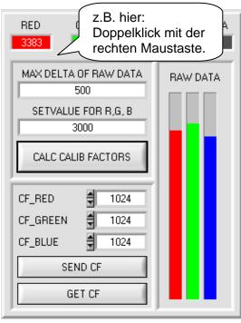
Um zur Offsetkalibrierung zu gelangen, muss in der Registerkarte **CALIBRATE** ein Doppelklick mit der rechten Maustaste irgendwo zwischen den einzelnen Elementen durchgeführt werden
